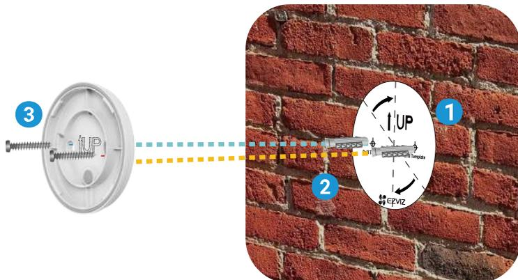
4. Coloque la Sirena en la base de montaje y luego gírela en el sentido de las manecillas del reloj para asegurar completamente los acopladores de la Sirena y las ranuras de ajuste de la base de montaje.
